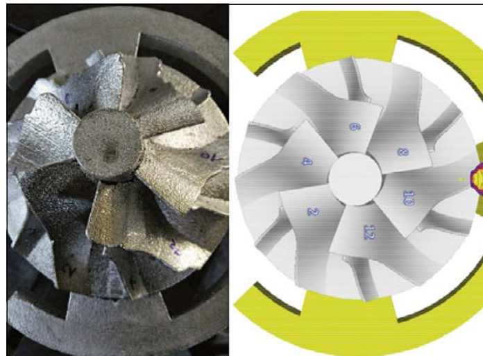
Bild 14: Die größeren Schaufeln wurden von 2 bis 12 nummeriert – die kleineren Schaufeln wurden von 1 bis 11 nummeriert (nicht gezeigt).
