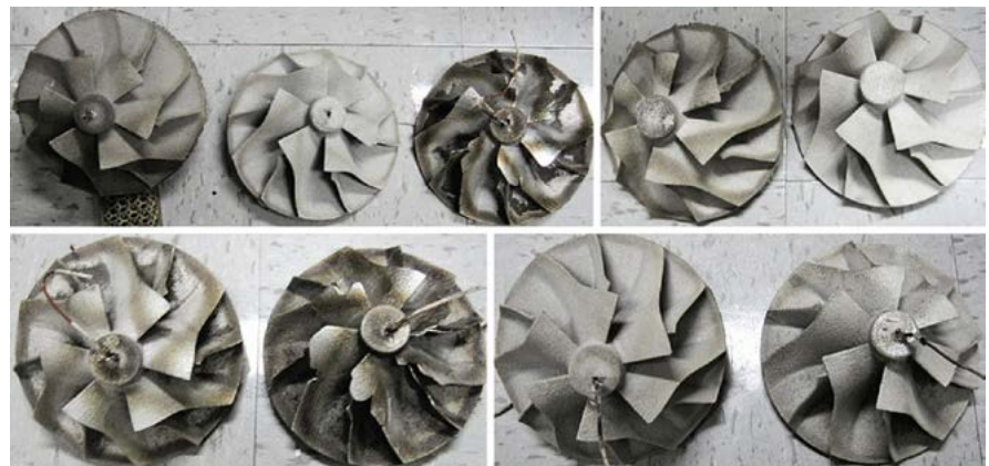
Bild 8: Die Rotoren 1 bis 9, gegossen im Niederdruckverfahren; die Rotoren 4 und 5 waren ohne Thermoelement.
