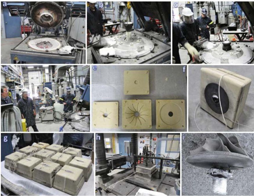
Bild 7: Darstellung der Forminstallation und des Gießens auf der Niederdruck-Gießmaschine (Legende siehe oben).
